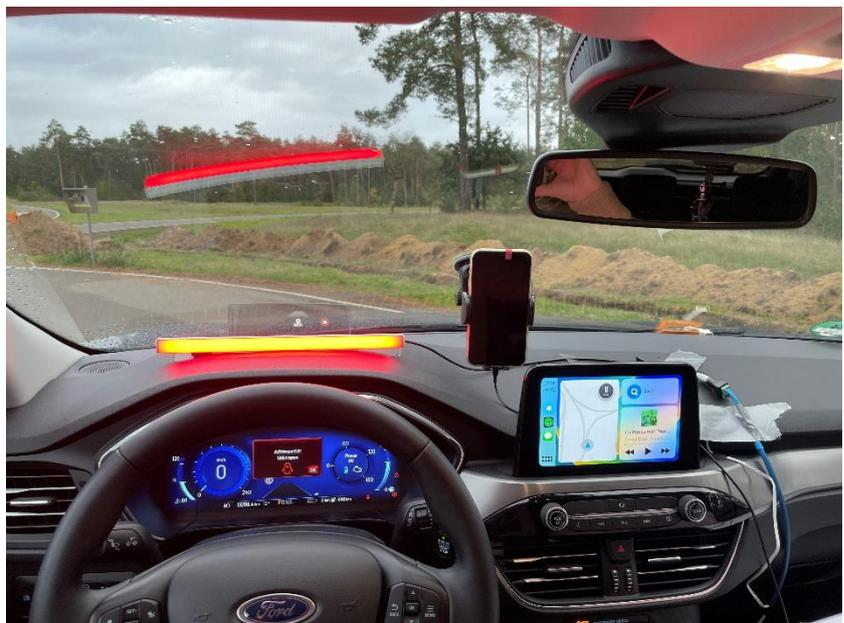
Figure 5 Illustration de la position des écrans du smartphone et du véhicule, et de la bande LED activée.
