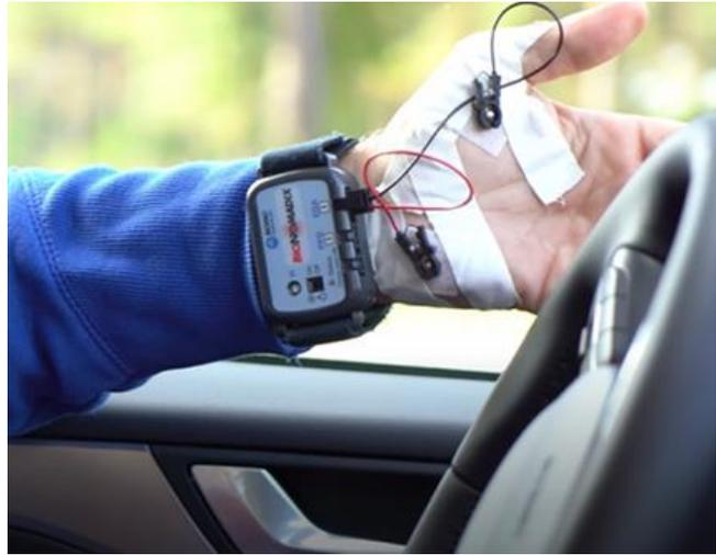
Figure 9 Illustration de la mesure de la conductance cutanée
